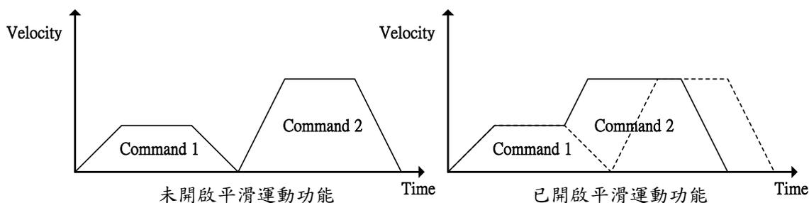
由圖中可以看出開啟平滑運動功能後的運動情形，第一筆運動命令在達到等速段後不經減速段，而直接加速至第二筆運動命令的等速段(如右圖之實線所示)，如此命令的執行時間較快，但各筆命令的连接處會有軌跡失真的狀況存在。
